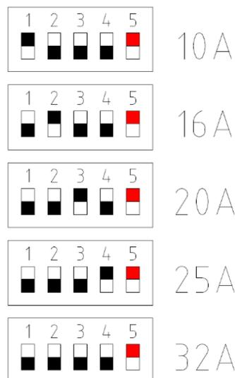
Tijekom instalacije maksimalna struja punjenja može se postaviti uklanjanjem poklopca upravljačke jedinice. Vodite računa da zadana vrijednost ne prelazi opteretivost vodiča koji se koriste za spajanje strujnog kruga. **Mikroprekidač 5 mora biti uvijek uključen jer isti uključuje detekciju 6mA DC i funkciju prekidanja strujnog kruga!**
